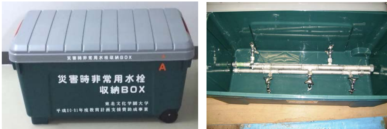
写真 5.2.7 災害時非常用水栓収納 BOX（外観および収納状況）
