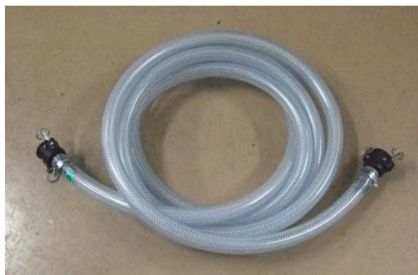
写真 5.2.4 給水栓ユニット・受水槽接続用ホース
